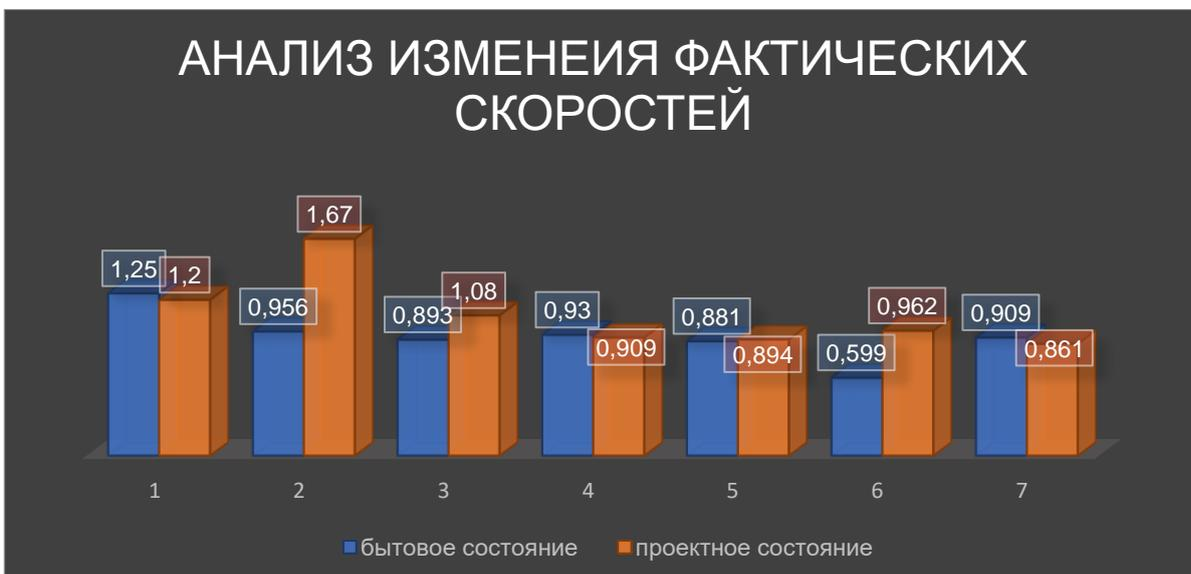
Рисунок 4 – Сравнительный анализ фактических скоростей до и после проведения дноуглубительных работ
