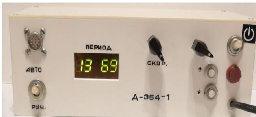
Рисунок 1 – Внешний вид прибора функционального управления шаговым двигателем
