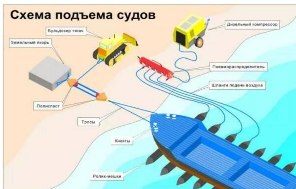
Рисунок 2 – Технология применения пневматических ролик-мешков
