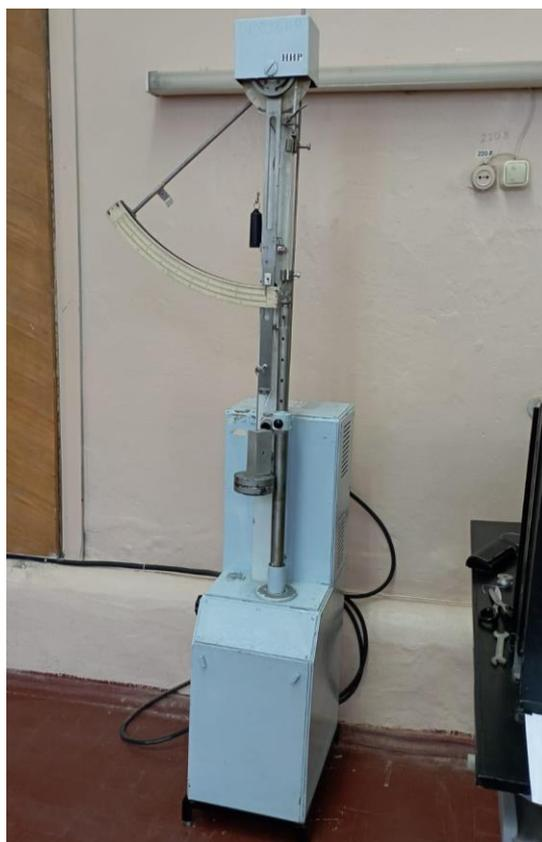
Рисунок 4 – Разрывная машина PM-30-1
