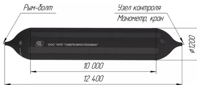
Рисунок 1 – Схема пневматического ролик-мешка для спуска и подъёма судов
